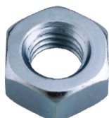
➤ ÉCROU HEXAGONAL HU 6 PANS PAS FIN ACIER ZINGUE BLANC CLASSE 8 - DIN 934
